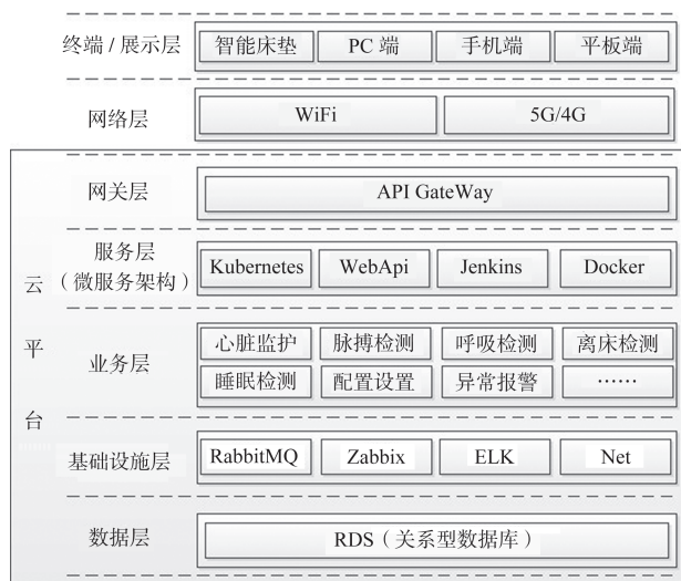
图3 基于物联网和云平台的患者智能监测系统整体系统架构
