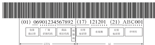
图2 基于GS1标准的UDI编码结构分析图
